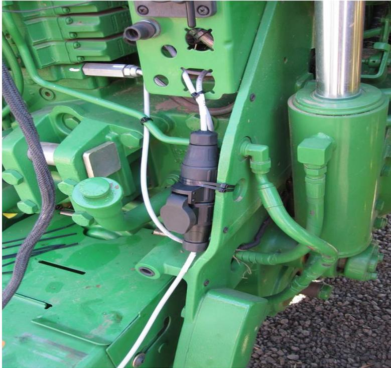
*Hinweis: Diese 7-poligen Schlepperstecker sind nur für das DSE4200 bestimmt und dürfen nicht an anderen Ausrüstungen angeschlossen werden, da hierdurch Schäden auftreten können.*
