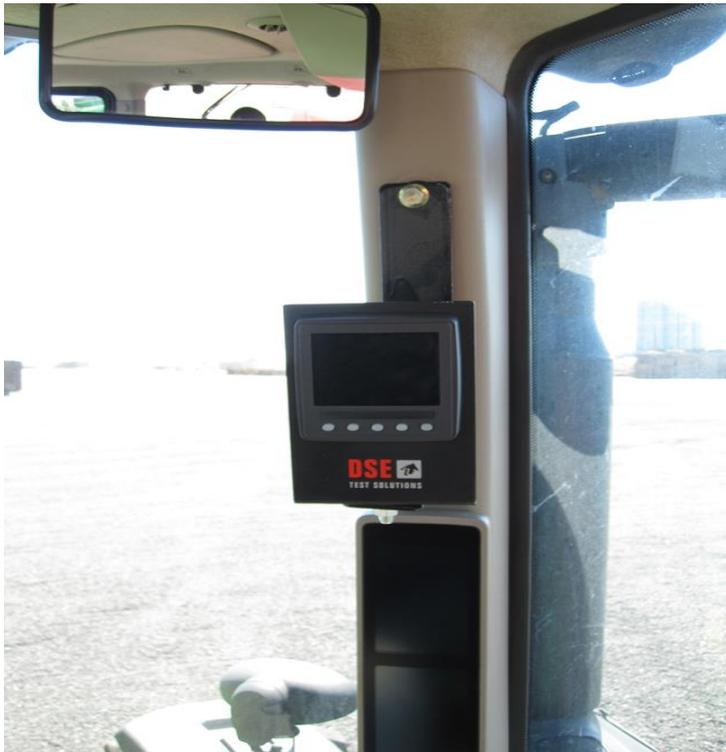
Eine Platzierung des Displays in direkter Sonneneinstrahlung sollte vermieden werden.
